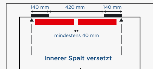
Position der inneren Spalte (z.B. durch Ausschneiden der Flügelüberschlagsdichtung)
