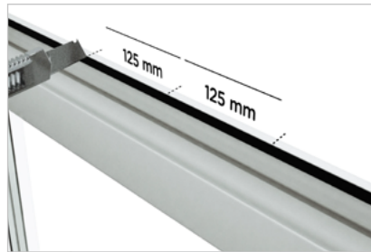
Anzeichnen und Entnehmen der Dichtung im Fensterflügel
